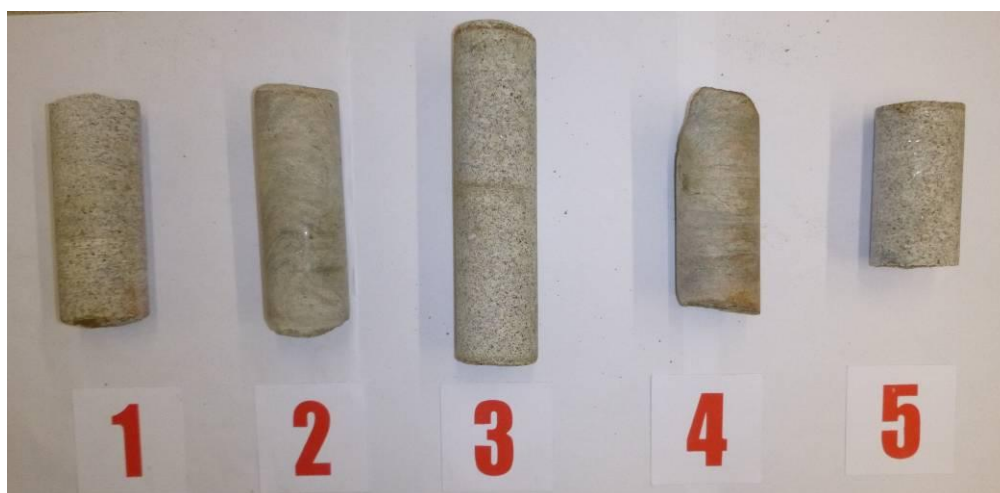
FOTO č.2: Dokumentace vzorků pro destruktivní zkoušky kamene opěr
