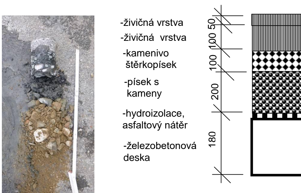
SCHEMA č.7: Skladba vrstev vozovky na mostě v místě SK1 – na mostě
