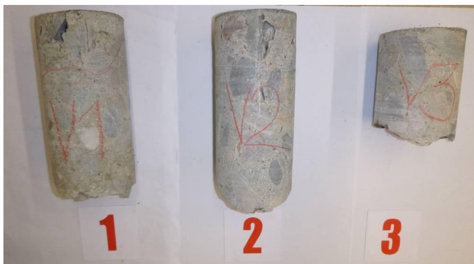
FOTO č.1: Dokumentace vývrtů pro destruktivní zkoušky pevnosti v tlaku betonu NK
